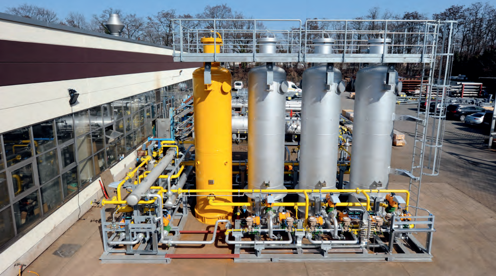
Hydrogen drying unit, Regeneration in a closed loop (1) | Drying of natural gas with integrated removal of mercury and CO 2 (2) Wasserstofftrocknung, Regeneration im Kreislauf (1) | Trocknungsanlage für Erdgas mit integrierter Quecksilber- und CO 2 -Entfernung (2)
